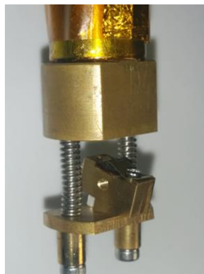
図 1 Magnet-on-cantilever 配置における ESR 測定用カンチレバーホルダー
