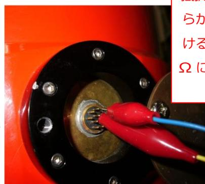
抵抗が 1.5Ω になったらどちらかの端子をはずし、再びつける。そうした後、抵抗が 6Ω になっていたらヘリウムのトランスファーは完了
