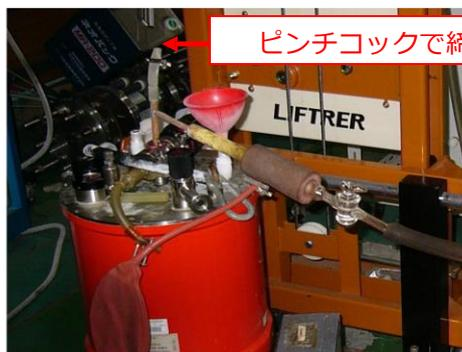
5. ヘリウム層に液体ヘリウムをトランスファーする。Ch 1 の右二つの端子で抵抗を見て、He の入り具合を確認する。1.5Ω でつなぎ換え、6Ω になるまでトランスファーする。
