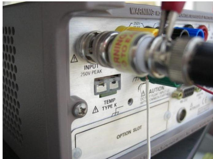
図 6 3 軸から 2 軸へ変換するプラグの装着図
