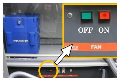
図 1-3 ICP 左横のドラフト (ファンスイッチ)
