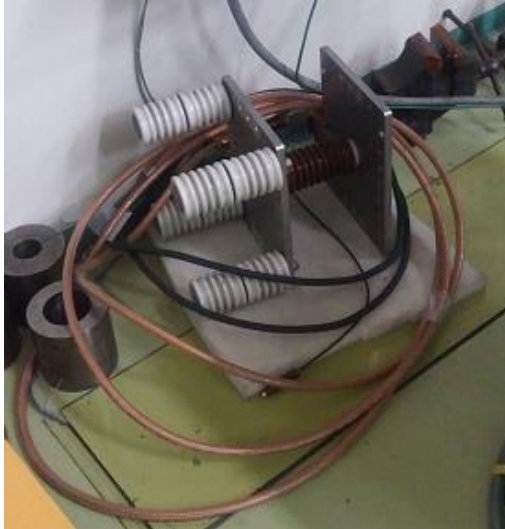
写真3 コイル破壊専用の配線セット
