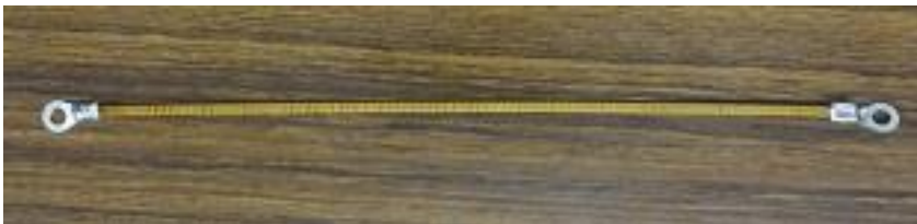
写真11 コイル作製の途中（磨いた両端に圧着端子を取り付けた。）
