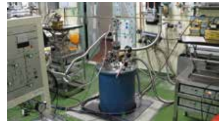
極低温電子スピン共鳴 (ESR) 測定装置
