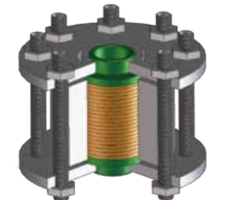
非破壊型パルスマグネット(金道式)の模式図
