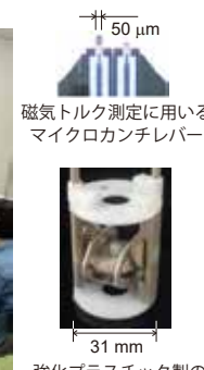
磁気トルク測定に用いるマイクロカンチレバー
